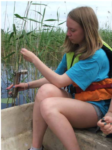
Фото 39. Отбор проб воды с помощью батометра в полевом лагере научно-познавательной экспедиции клуба «Непоседы» на оз. Вуокса (Фото Е.В. Архиповой)
