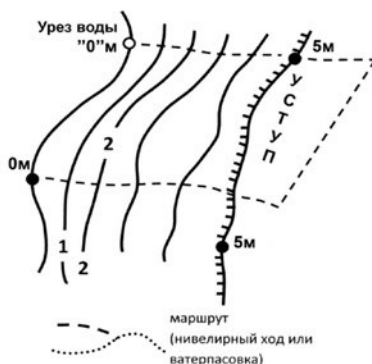
Рис. 11. Маршрут глазомерного хода через уступ
