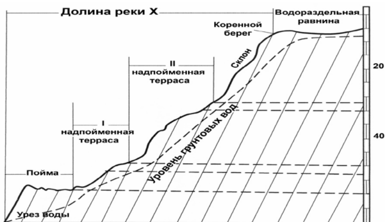
Рис. 19. Поперечный профиль склона долины реки X
