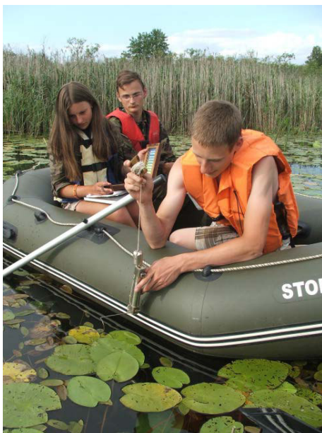
Фото 37. Отбор проб воды для гидрохимических исследований в полевом лагере научно-познавательной экспедиции клуба «Непоседы» в Вологодской области (Фото Е. В. Архиповой)
