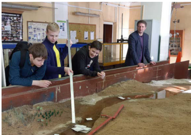
Рис. 14. Лаборатория водных исследований РГГМУ. Экспериментальная модель нижнего течения р. Луги (Ленинградская область). Мастер-классы «Моделирование ситуации ледохода и ледового затора» для участников фестиваля «В музей – сегодня, в науку – завтра!» 99
